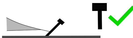
.=> Pour une bonne résistance, l'angle entre les piquets et l'attache doit être supérieur à 90°
