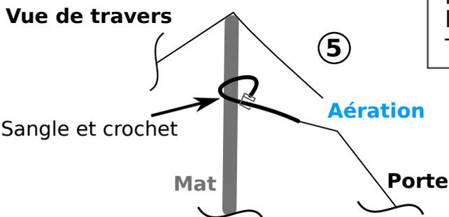
5) Ouvrir le haut de la porte et faire le tour du mat avec la sangle à crochet pour placer l'aération (schéma ci-contre)
